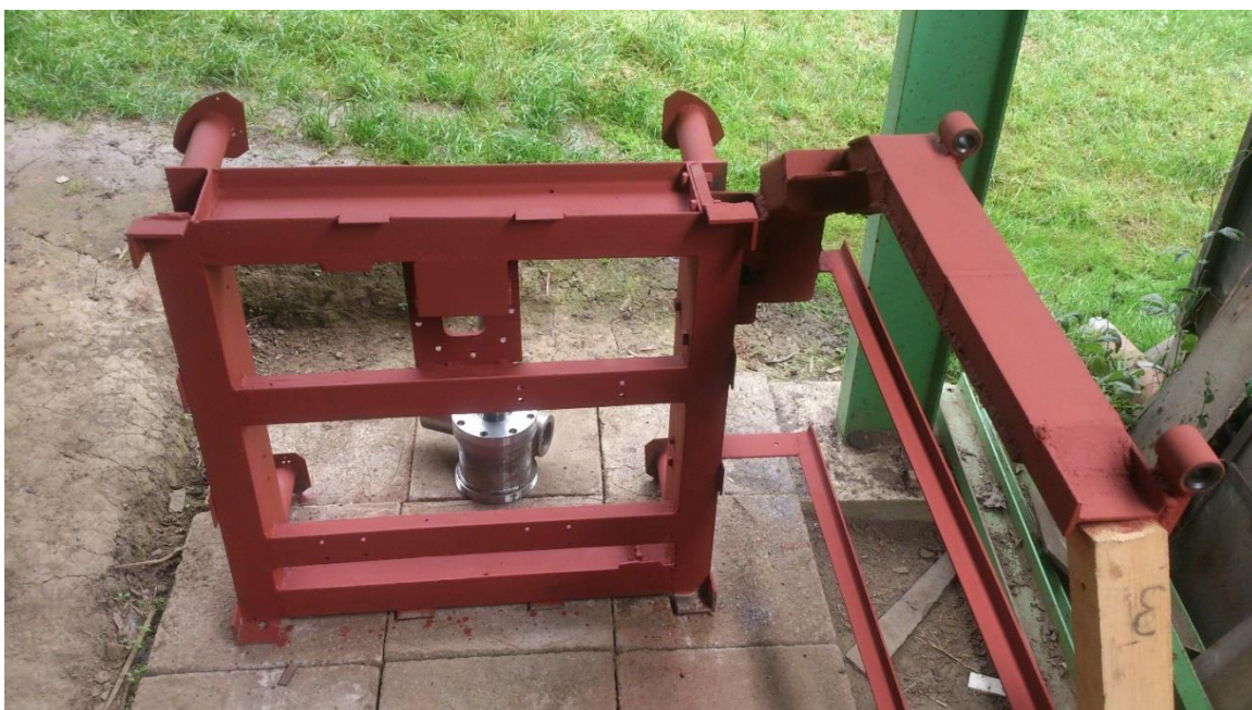
Obr. 31: Pohled na podstavu a rameno s panty pro dveře
