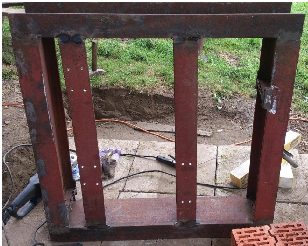
Obr. 29: Svařenec podstavu pece
