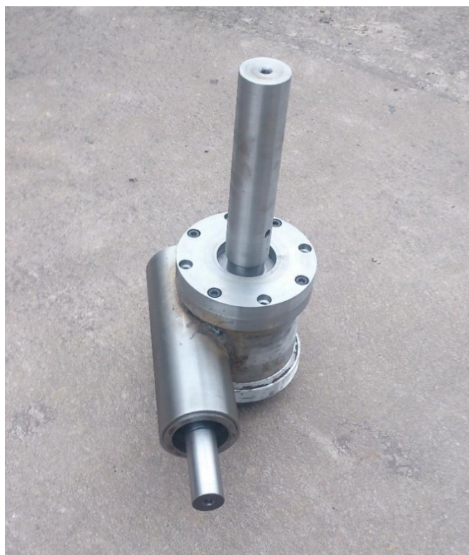
Obr. 28: Vyrobená šneková převodovka
