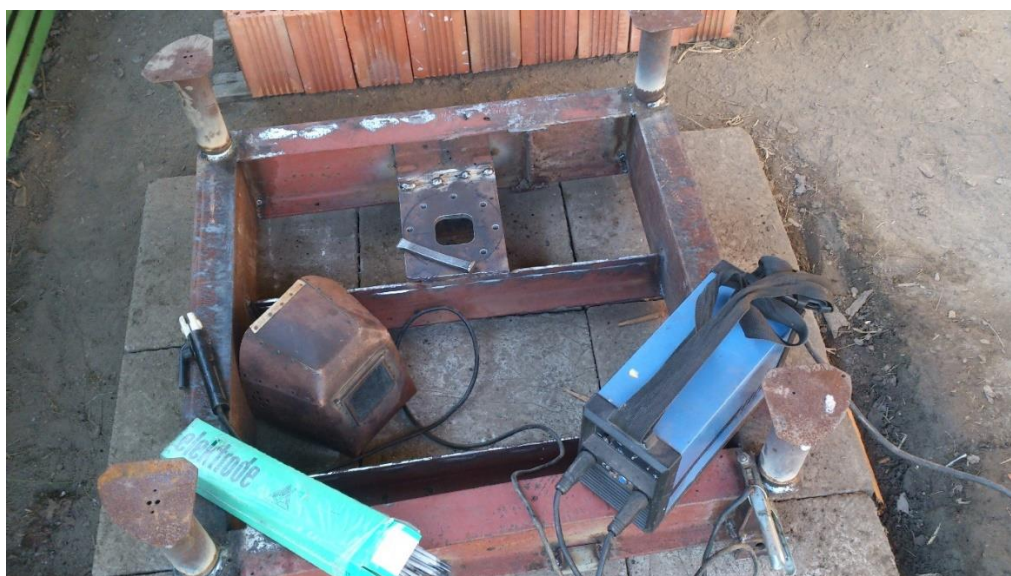
Obr. 29: Svařenec podstavu pece
