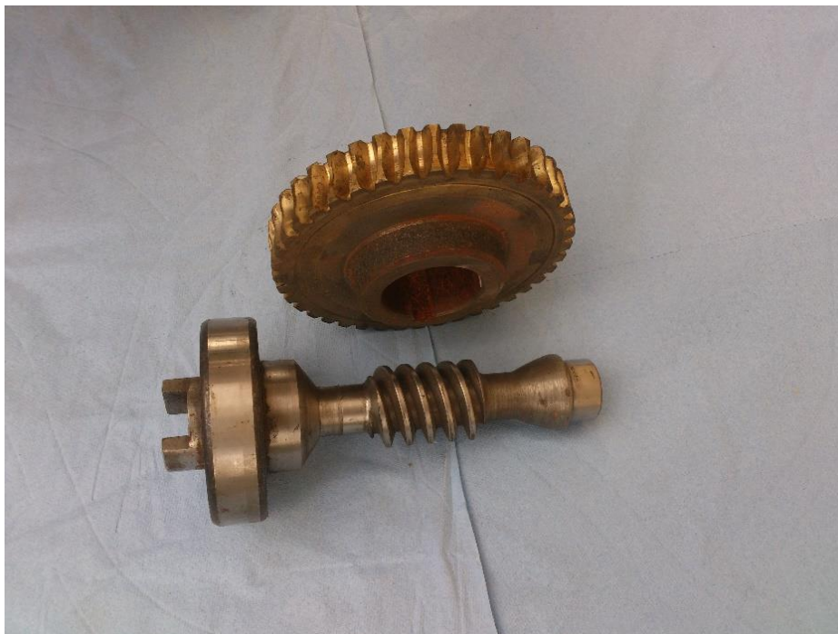
Obr. 27: Použitý šnek a šnekové kolo
